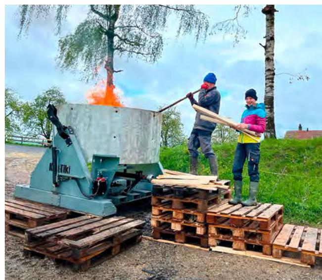
Bei der Herstellung von Pflanzenkohle im Kontiki-Ofen muss beachtet werden, dass alle Holzstücke ungefähr gleich breit sind, um eine effiziente Pyrolyse zu gewährleisten. (Bilder ©BeatFurrer)
