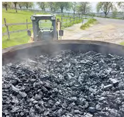
Die reine Brenndauer für die Füllung eines Ofens dauert in etwa vier Stunden. Mit Vorbereitung und Entleerung des Ofens muss mit sechs Stunden gerechnet werden. Zudem benötigt die Pflanzenkohle noch einige Tage, um zu trocknen.
